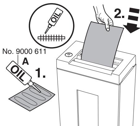
**ES** Si la capacidad de hojas se reduce o si la receptáculo está llena, recomendamos que lubrique el mecanismo destructor! (mirar dibujo) Para el modelo de corte en tiras utilizar el bote de aceite (**A**) Para el modelo de corte en partículas, utilizar el bote de aceite o las hojas con aceite (**B**) Consultar las referencias de ambos artículos (**A** y **B**) en la página 31.
