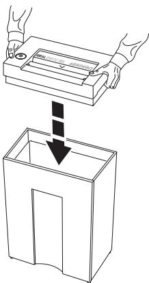
**DE** Maschine in den Auffangbehälter setzen.
