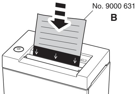
**DE** Bei nachlassender Schneidleistung oder nach jedem gefüllten Auffangbehälter Schneidwerk ölen! (siehe Bild)
