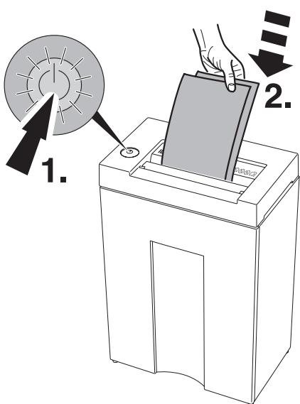
**SV** Tryck snabbt på knappen en gång (1.) : (1.). Grönt ljus visar "klar att använda", startar automatiskt när papper förs in (2.). Tryck på knappen och håll den nedtryckt (1.) för manuell inmatning. Maskinen startar och strimlar det återstående papper i inloppet. Därefter automatisk start när du sätter i papper. Stannar automatiskt när inget papper matas in. Se para automaticamente cuando acaba de destruir el papel.
