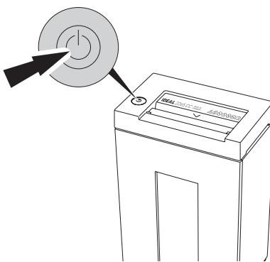
**ES** Modo de espera automático que se apaga tras 15 minutos. La máquina puede apagarse en cualquier momento pulsando la tecla . El indicador LED verde se apaga . Con ello, no hay habrá ningún consumo.
